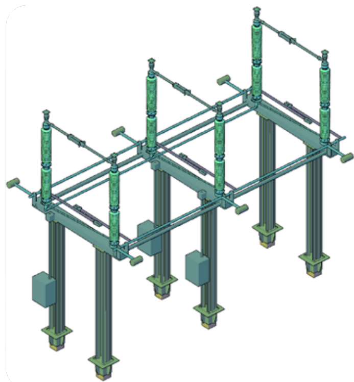
Модель разъединителя РПД922092, созданная в Model Studio CS OPY
